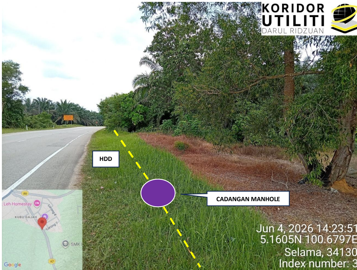
JAJARAN HDD DAN MANHOLE DI JALAN TAIPING – SELAMA (A7)
