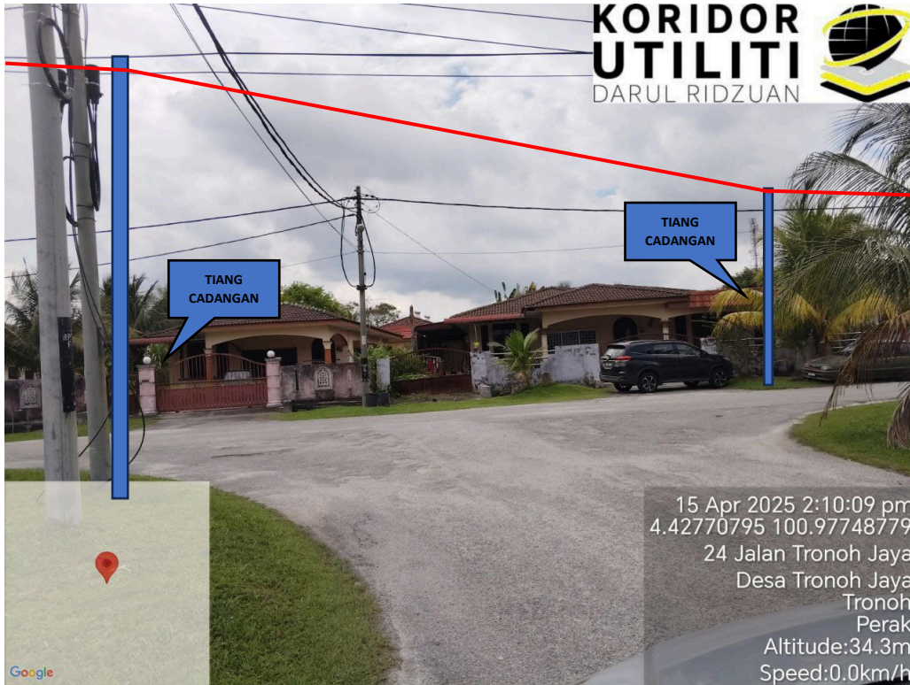
JAJARAN PENANAMAN TIANG DI JALAN TRONOH JAYA
