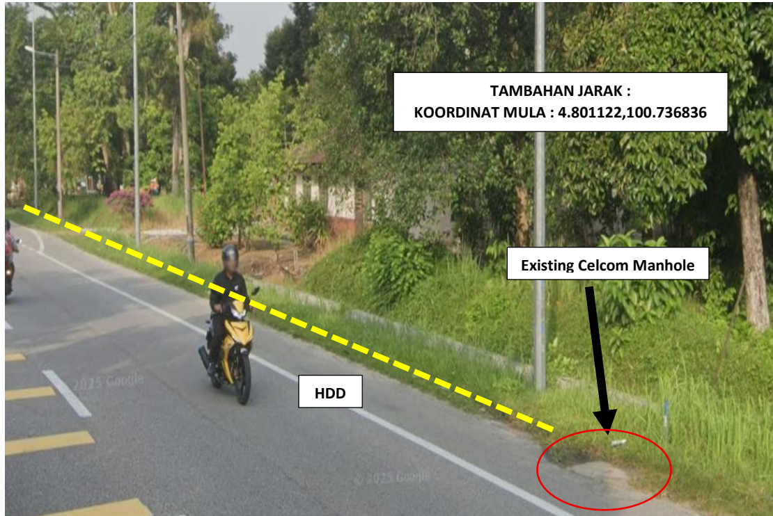
TERDAPAT TAMBAHAN JARAK - CADANGAN HDD DI JALAN AIR KUNING (A109) (Sambungan dari existing celcom manhole)
